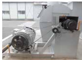
平型ベルトに交換された大型集塵機の駆動モーター
