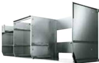
2011年に発売した「ecoキャビ」には、世界初のステンレス素材「NSSC®FW1」を使用しました。ステンレスはリサイクル率が80%以上の環境にやさしい素材ですが、「NSSC®FW1」はレアメタル(クロムやニッケル)の含有量をSUS304と比較して、約46%削減した注目の新ステンレス素材です。
