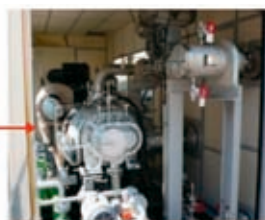
蒸気タービン式コンプレッサー(蒸気駆動式空気圧縮機)
