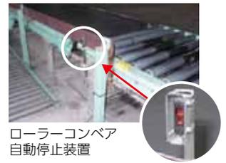
ローラーコンベア自動停止装置
