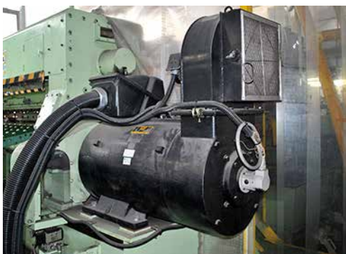
55kW モーター (写真はロータリーシャー駆動用)
