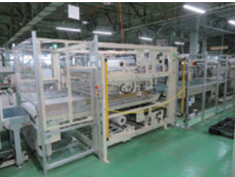
シュリンク梱包機 (鹿児島システム工場)
