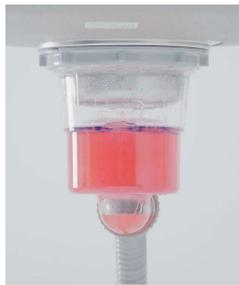
※上図の試験条件：絵具と食紅で赤に着色した水道水に油性インクで青に着色した食用油を浮かべ、一般的なトラップは水栓から6L/minの流量を17秒吐水した状態。かってにクリントラップは1回洗浄運転をした状態。（両トラップ共に使用水量は1.7L）
