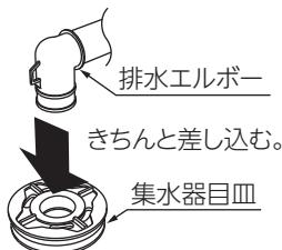
排水ホースエルボー部先端の突起が集水器皿皿の奥に引っ掛かるように確実に差し込んでください。
