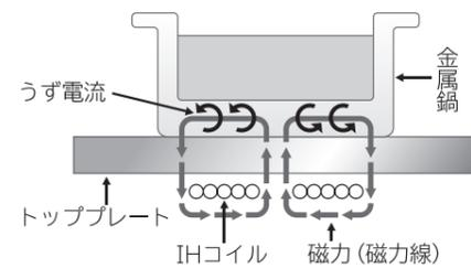
IHとは電磁誘導加熱(Induction Heating)のこと。IHコイルから発生した磁力(磁力線)が、金属製の鍋を通るとき、うず電流が発生し鍋自体を発熱させます。
